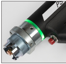
Bolzenschweißpistole PS-9 mit neuartiger Bedienungsführung durch eine mehrfarbige LED-Anzeige (Gebrauchsmuster-Nr.: 20 2009 012 370.7)
