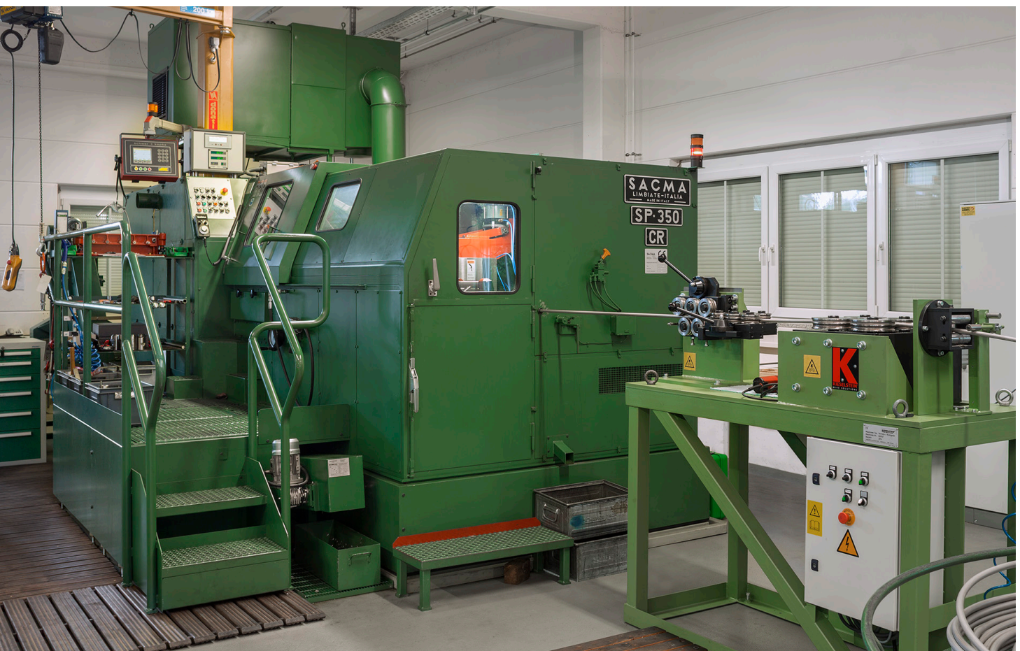
Modernste Kaltstauchpressen für Schweißbolzen bis Ø 16 mm Most advanced cold heading presses for welding studs up to Ø 16 mm
