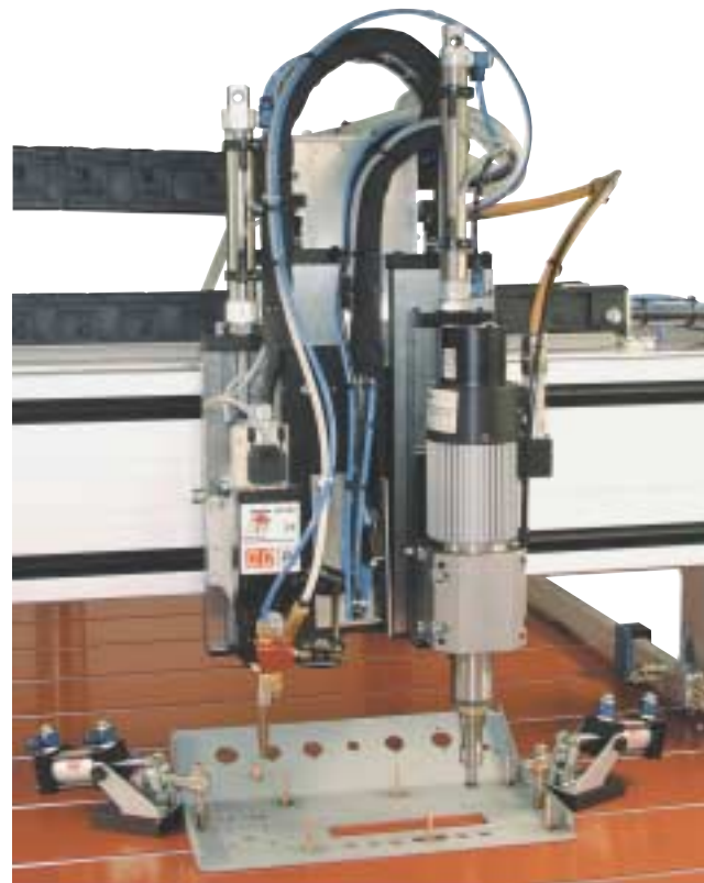
Schweißkopf SK-5AP mit Digitalanzeige zur präzisen Messung des Abhub- und Eintauchweges in Kombination mit einem Fräs-/Bohrkopf
